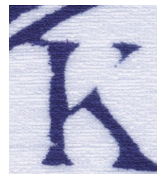
色浸食（現象が出ているもの）
